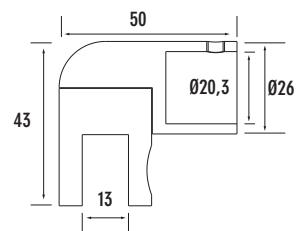
\* Material: Messing massiv, glanzverchromt ; Produktion intern.
