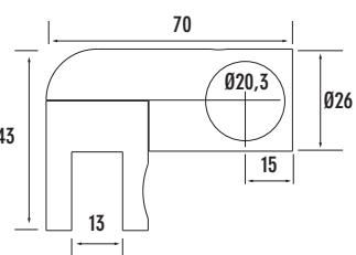
\* Material: Messing massiv, glanzverchromt ; Produktion intern.
