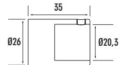
\* Material: Messing massiv, glanzverchromt ; Produktion intern.
